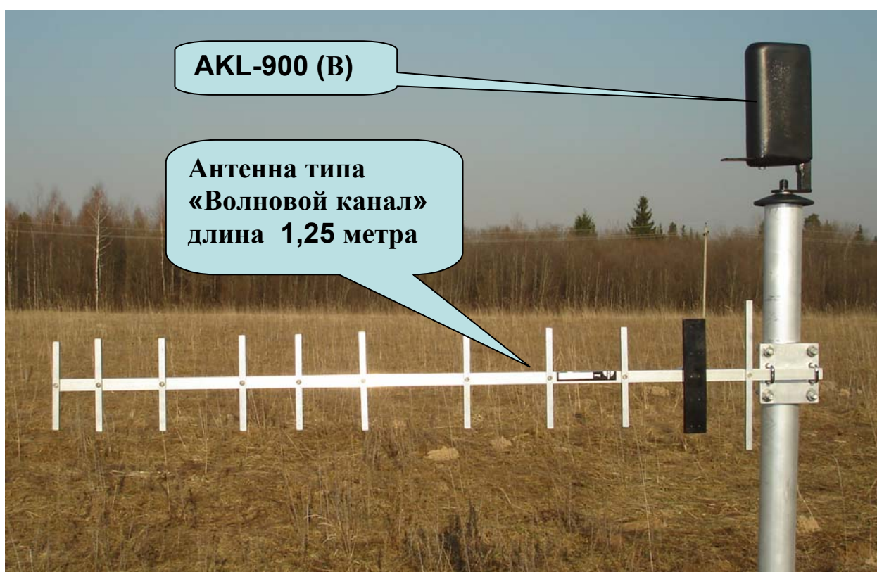
Рис.5 Антенна типа «Волновой канал» (КУ=14 dB) и «AKL-900 (B)»
